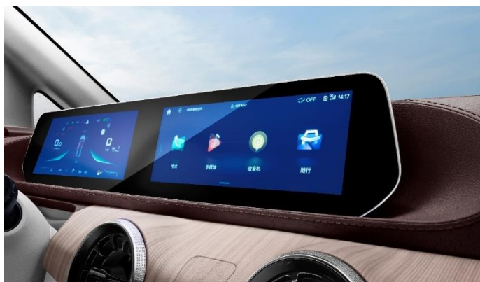
HD дисплей, состоящий из 2-х экранов с общей диагональю 20,5"
